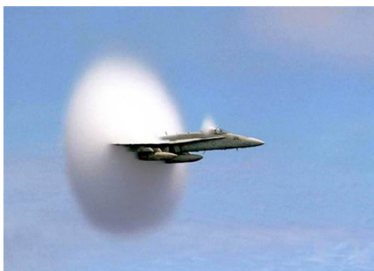
Fig. 16. Condensación por depresión inducida en vuelo ( NASA ).
